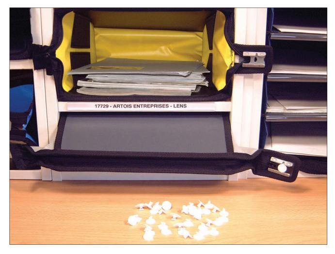
Ce système de sécurité est spécialement conçu pour les fermetures à glissière. Il est composé d'une chambre, fixée sur le sac, et d'un consommable, le scellé.
