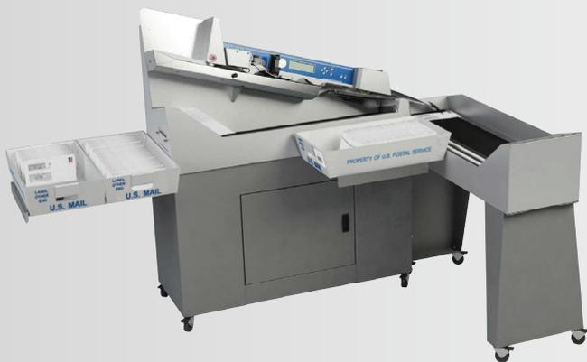
Capable de distinguer le « courrier principal » du « courrier secondaire », le modèle 306s permet de garantir une productivité maximale par l'ouverture et le tri des enveloppes en un seul passage.
